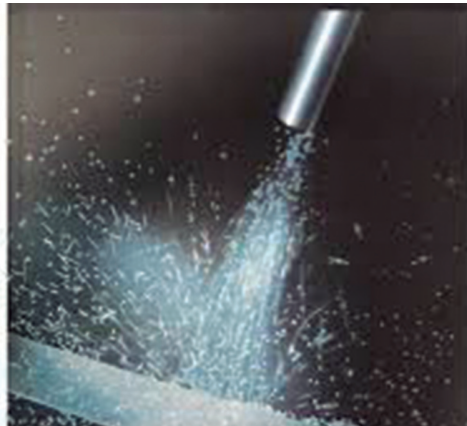
Figura 29. Proceso de shot blasting sobre una superficie metálica.
